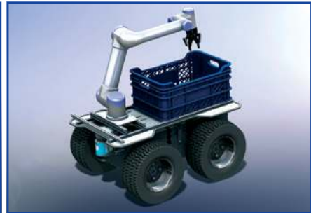
Innok Heros 444 mit Roboterarm, Greifer und Transportbox
