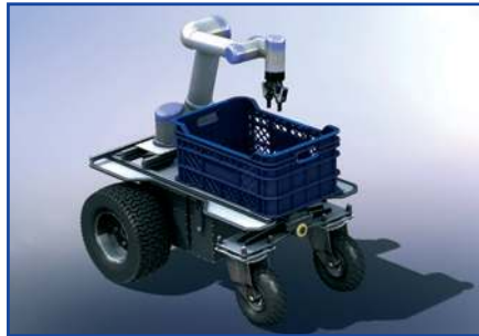
Innok Heros 224 mit Roboterarm, Greifer und Transportbox
